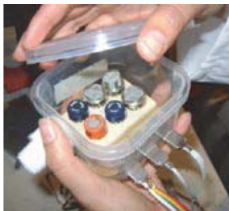
شکل ۳- محفظه حسگرهای گازی
